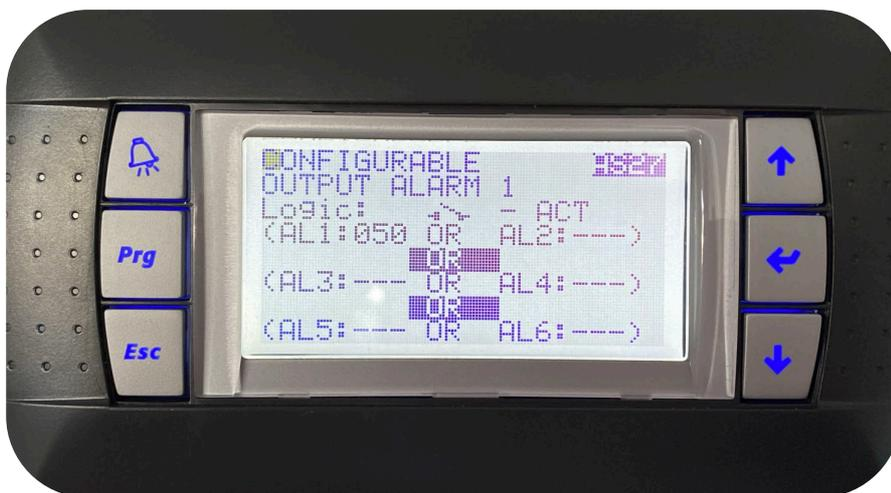
Pour configurer le seuil de haute température, nous avons besoin du paramètre **AS45**. Ici, le capteur de température peut être sélectionné (l'entrée est l'allée chaude ; la sortie fait référence à l'allée froide). Le point de consigne d'activation de l'alarme peut être défini, ainsi qu'un différentiel et un retard si cela est requis.
